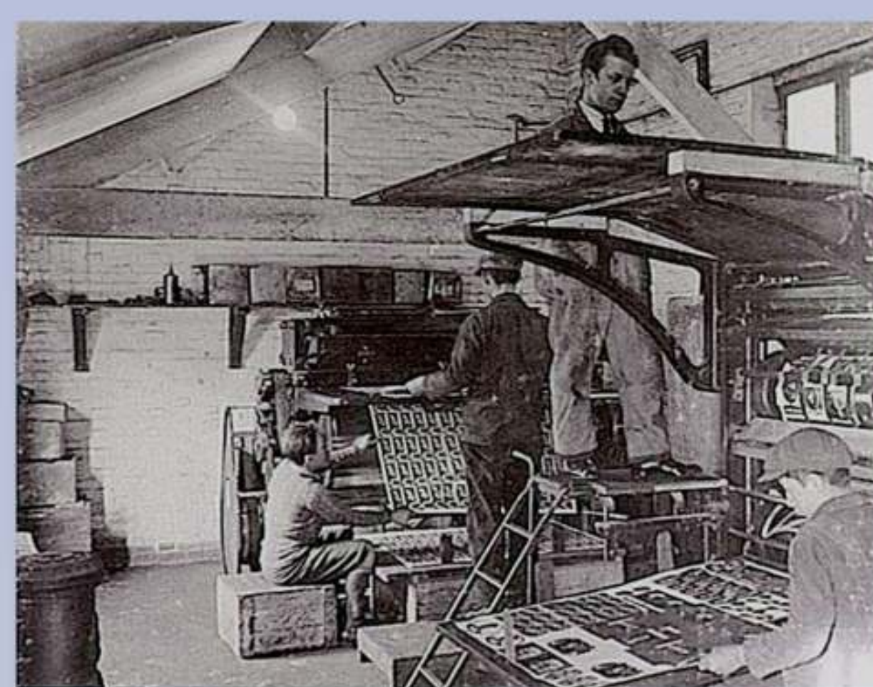
De achterste machine is een bronsmachine voor het aanbrengen van goudbrons. De voorste machine is een kalenderpers, goudpletten.
