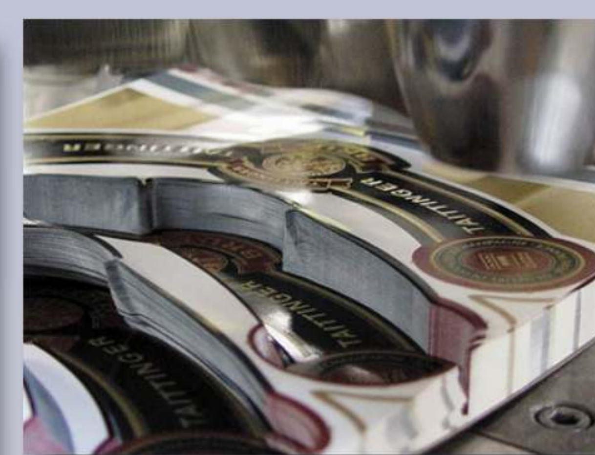
Bovenin zijn de stansen te zien die het etiket zijn definitieve vorm geven.
