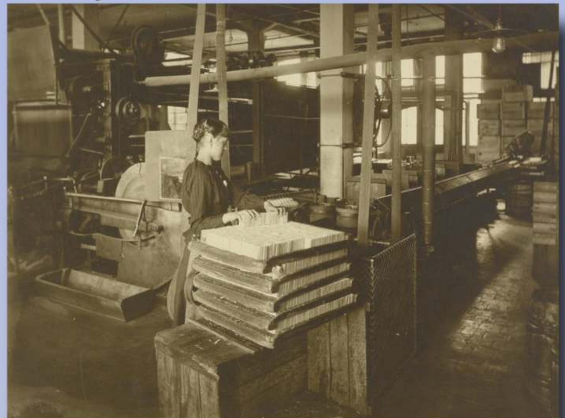
Aanstrijkmaschine, dienende om de aanstrijkmasa op de doosjes aan te brengen. Het meisje zorgt alleen voor het invoeren van de doosjes.
