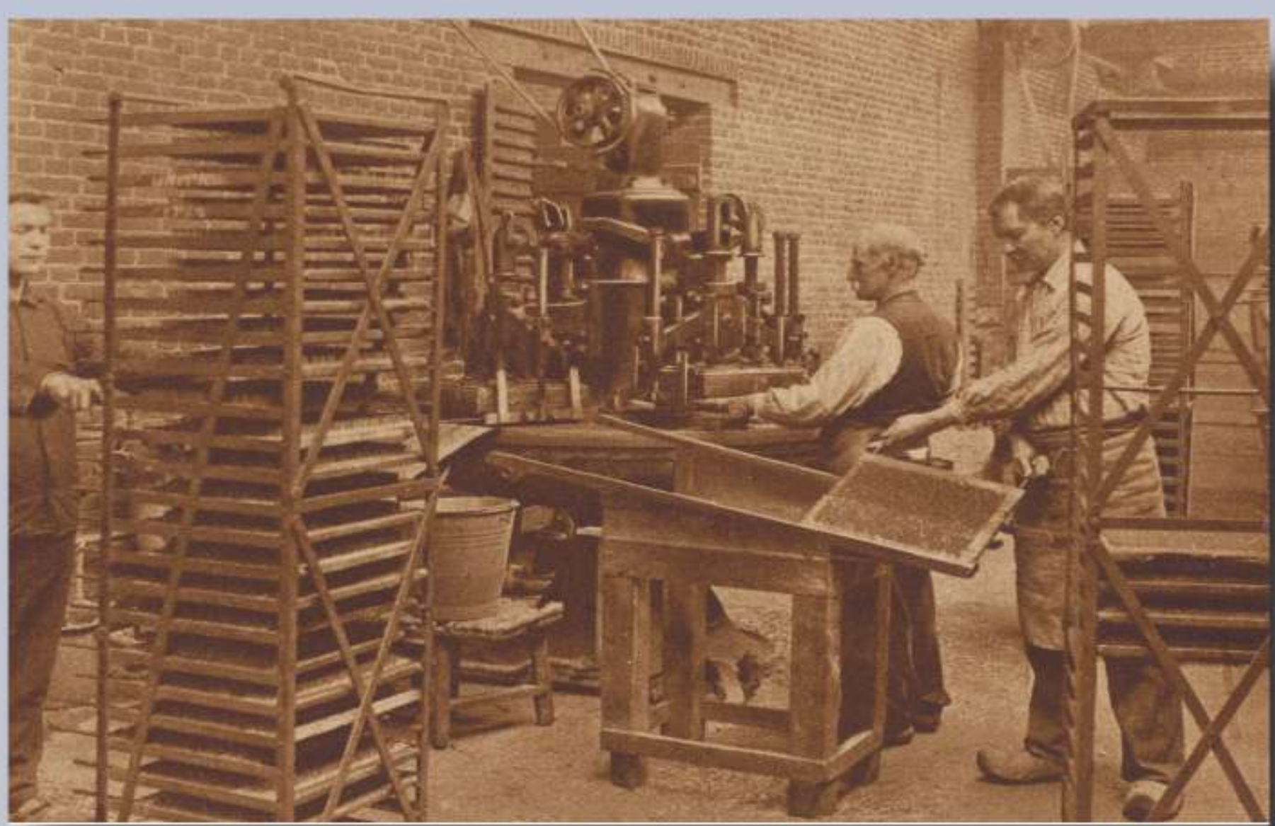
Nadat het eind van het stokje door de paraffine is bevochtigd om het hout beter te doen branden, is het aangestoken en voorziet men de lucifer van een gele kop. Een bord met stokjes wordt door de machine enige malen in de zwavel gedoopt, waarna de lucifers voor afstrijken gereed zijn.
